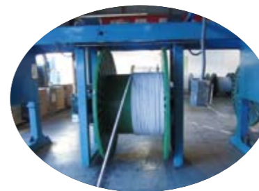
护套过程中骨架缆芯放线
