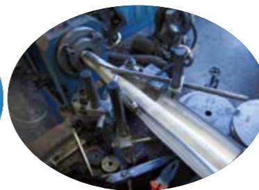
护套过程中纵包铝带成型
