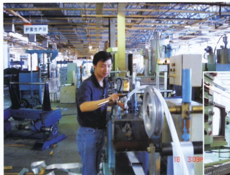
▲ 王华斌工程师在720芯骨架缆护套线现场调试
